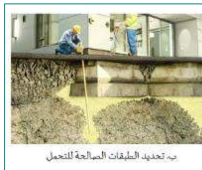
الشكل (2): خطوات حقن التربة بالأسمنت
