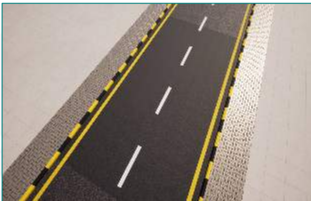
امتداد منطقة الإصلاح لحارة المرور المجاورة
