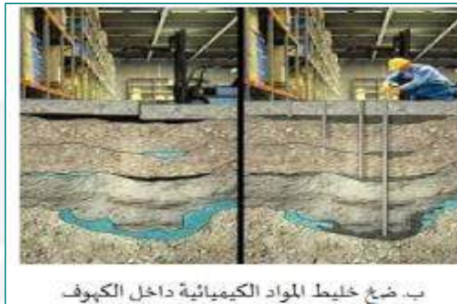
الشكل (3): معالجة التكهفات بالمواد الكيميائية
