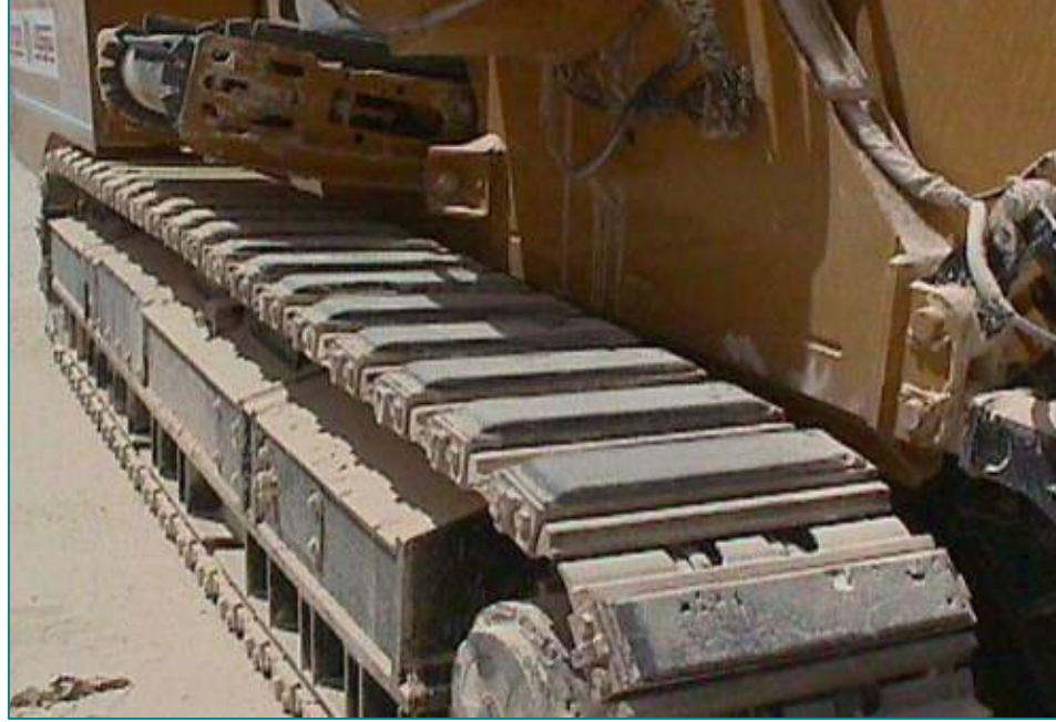
الشكل (13): التغطية المطاطية للجنزير لحماية سطح الأسفلت
